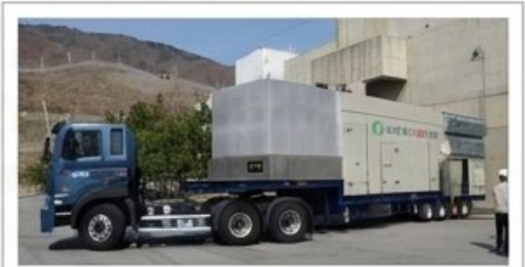
3.2MW / 1MW 이동형 발전차
