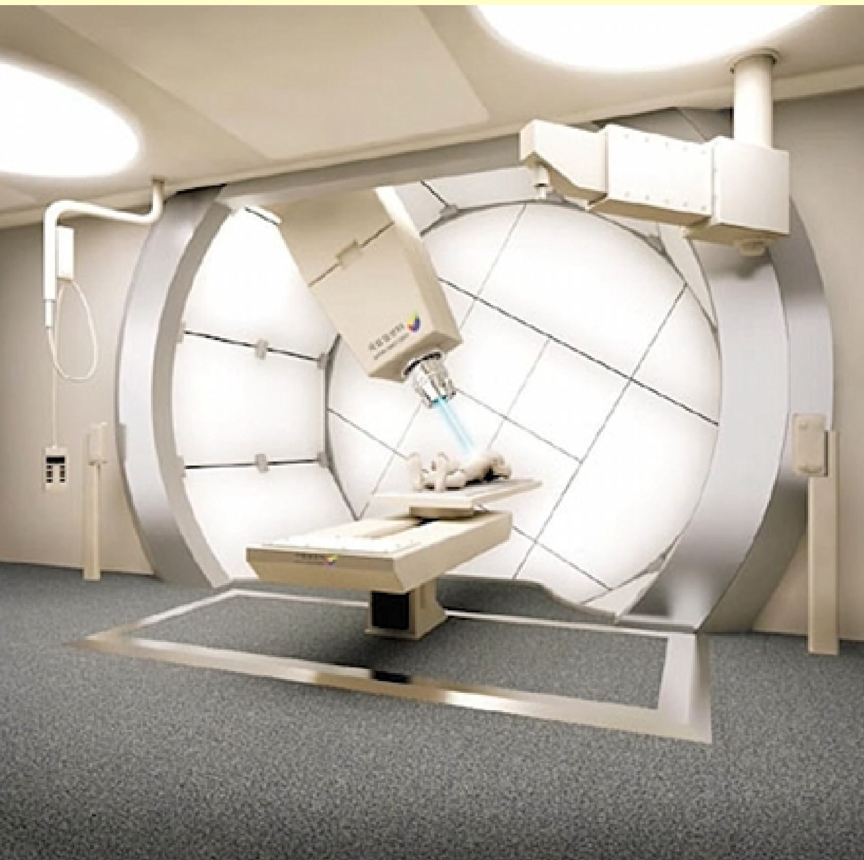
3) 방사선 조사 방향을 정밀하게 회전시키기 위한 방사선 치료의 기계적 장치
